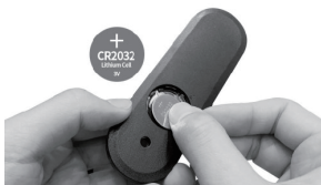
3. Ouvrez le couvercle de la batterie pour retirer la batterie.
