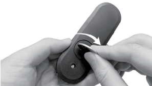
4. Faites pivoter le couvercle de la batterie comme avant après avoir remplacé la batterie.
